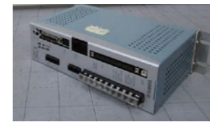
装置名 ロボットコントローラ メーカー名 ヤマハ発動機 型番 SRCX20 故障症状 通信エラー発生。
