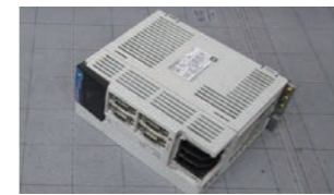
装置名 サーボドライバ メーカー名 三菱電機 型番 MR-J2S-40B 故障症状 E9が発生し、動作しない。
