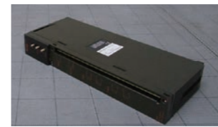
装置名 PLC (Aシリーズ) メーカー名 三菱電機 型番 A62DA 故障症状 電圧が指令通り出力されない。
