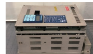
装置名 インバータ メーカー名 安川電機 型番 CIMR-H15WS 故障症状 FU (ヒューズ溶断) で異常発生。
